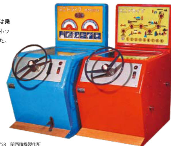
'58 関西精機製作所 ミニドライブ 日本のドライブゲームの原点ともいべき作品。車の模型の下で曲がりくねった道がベルト式に手前に回転するので、車の模型が道から外れないようにハンドルで左右に動かす。写真は右側が初期型のM型で、左側がアクセルのついたMA型。 CLASSIC VIDEOGAME STATION ODYSSEY 2001 http://www.ne.jp/asahi/cvs/odyssey/
